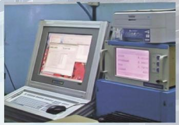
Лазерный контрольно-измерительный комплекс предназначен для прецизионного контроля внешних размеров прутков, валов, трубок, прокатного инструмента и других изделий имеющего форму вала, а так же для автоматической корректировки управляющей программы дошлифовки прокатного инструмента.
