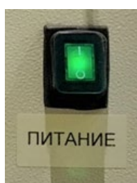
Рис. 6. Тумблер питания на панели оператора
